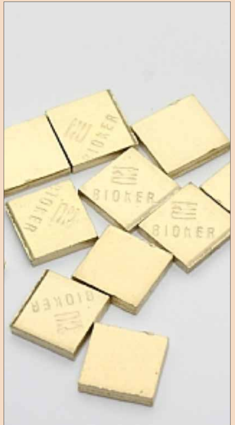
Visoko-zlata dentalna zlitina BIOKER za porcelansko tehniko s kemijsko sestavo (v masnih %): Au 85,90%; Pt 11,70%; Zn 1,50%; ostalo (Rh, Ir, Nb, Mn, In, Fe) <1%
