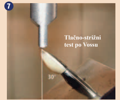
Shematski prikaz tlačno-strižnega testa po Vossu.
