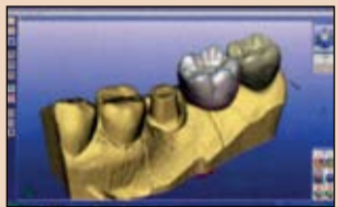
Εικ. 4 Εικόνα της κατασκευής μέσω συστήματος CAD για επιεμφυτευματικές στεφάνες.
