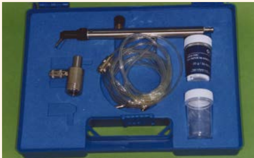
Figura 1. Imagen de los componentes como la manguera de conexión, voladura contenedor de polvo, así como acoplamiento y adaptadores opcionales que se incluyen en la entrega.
