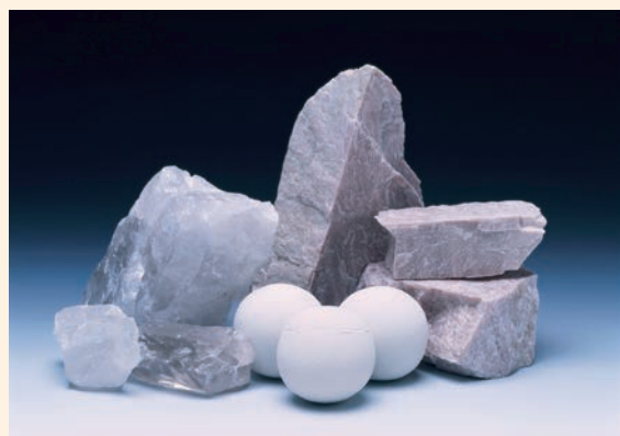
5. ábra: Kvarc és kálium-földpát – a leucittartalmú dentálkerámiák gyártásának hagyományos nyersanyagai, amit kemény porcelánról elemekkel finom porrá őrölnek.
