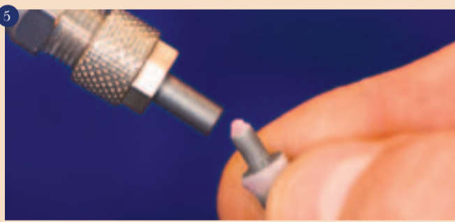
Spesčajte vezavno površino Ti nadgradnje z 50 µm Al 2 O 3 in maksimalno 2 bari.
