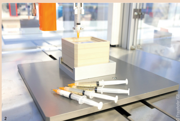
Abb. 2: Spritzen mit verschiedenen Biotinte-Formulierungen.
