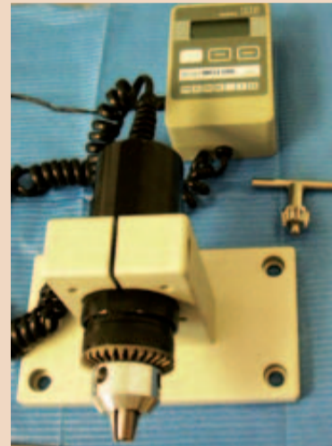
Versuchsaufbau mit Messfutter.
