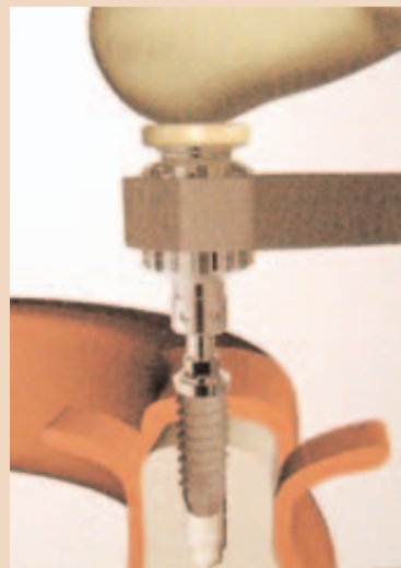
Verschlusschraube des Implantates mit einer Drehmomentratsche.
