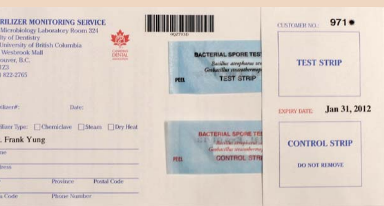
Ryc. 2: Przykładowe wskaźniki, które poddawane są testom wykazującym poziom skuteczności sterylizacji narzędzi w gabinecie.
