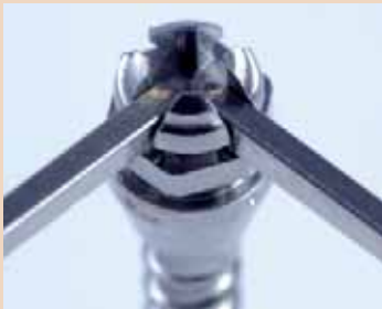
Obr. 3 a - c: Pokud má být drát ohnut do pravého úhlu v drážce minišroubu (a), musejí být odstraněny hrany v místě křížení drážek. Tento výhodný detail se běžně nachází pouze u OrthoEasy FORESTADENT (b) a u tomas-pin od DENTAURUM (c).
