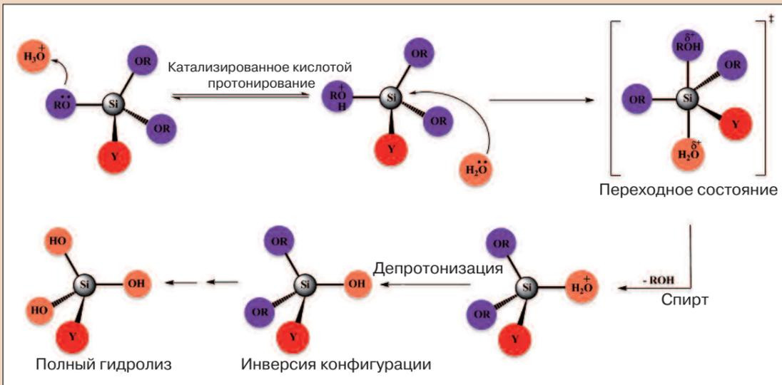
Рис. 1. Механизм гидролиза силана.
