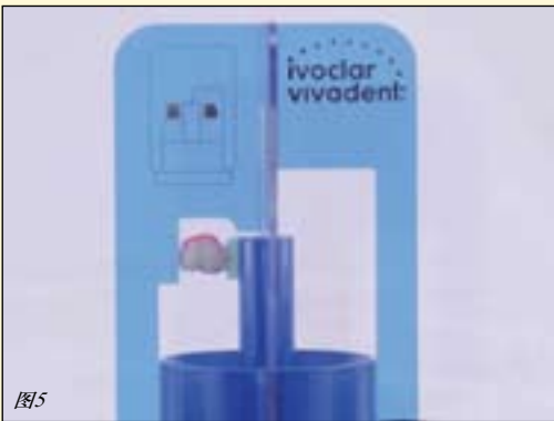
图 4：安装好铸道的修复体蜡型与铸圈底座相连。图 5：模版（IPS e.max Press Multi 铸道导板）用以确认蜡型在铸圈中的位置。图 6：安装好的铸圈底座。
