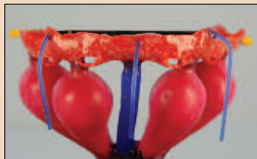
Рис. 16. Снабженная литниками и стабилизирующей балкой супраструктура.
