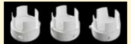
图3: 使用VITA YZ氧化锆材料制成的齿形样品, 壁厚分别为0.2mm, 0.3mm, 0.4mm (从左至右)。
