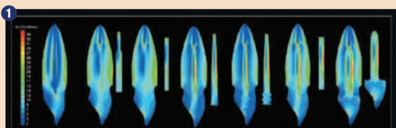
Material zatička (steklena vlakna, kremenova vlakna, cirkonov oksid, zlato, kovina ali titan) vpliva na porazdelitev napetosti in ima pomemben vpliv na koncentracijo moči med žvečenjem.
