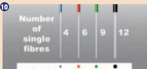
Slike 8-10: Zatiček iz steklenih vlaken se izbere glede na premer kanala. Sistem zato omogoča različne velikosti glede na zahteve uporabe. Po vstavljanju zatička smo odstranili manšeto, ki drži skupaj sveženj steklenih vlaken, da so se vlakna lahko porazdelila po notranjosti kanala. Nato smo sveženj zatička fiksirali s svetlobno polimerizacijo.
