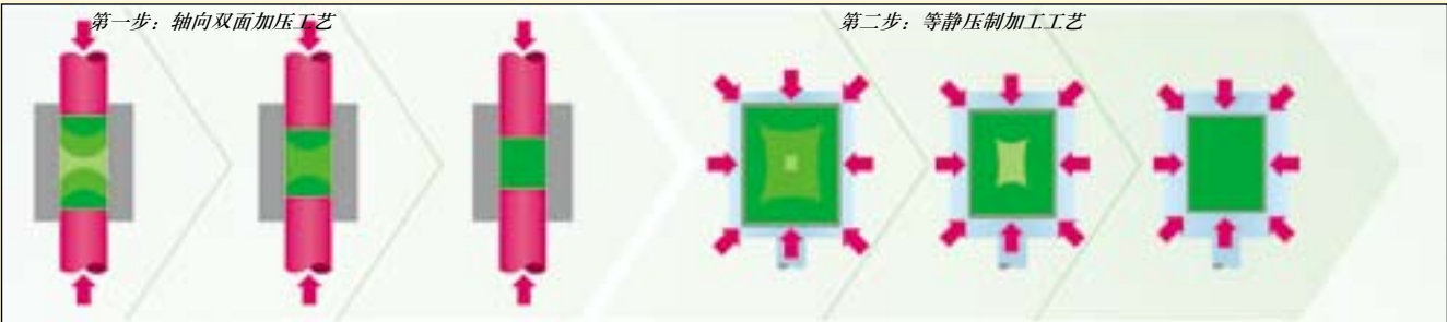
图2：VITA YZ系列氧化锆材料的冲压工艺原理图。
