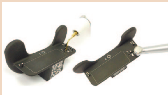
Рис. 8, а. Калибровка оси бора и его кончика.
