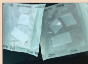
Рис. 1. Отрезки тефлоновой ленты подготовлены к автоклавированию.
