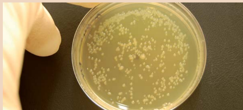
Bei sofortiger Ozon-Begasung treten nach einer Minute größere bakterienfreie Flächen auf.
