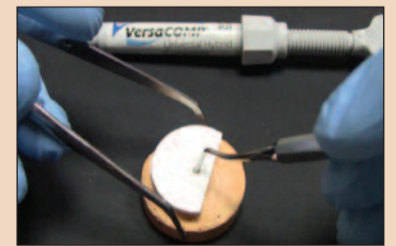
Рис. 7. Установка композитного столбика на поверхность цемента.
