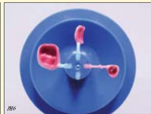
图4: 安装好铸道的修复体蜡型与铸圈底座相连。图5: 模版 (IPS e.max Press Multi铸道导轨) 用以确认蜡型在铸圈中的位置。图6: 安装好的铸圈底座。
