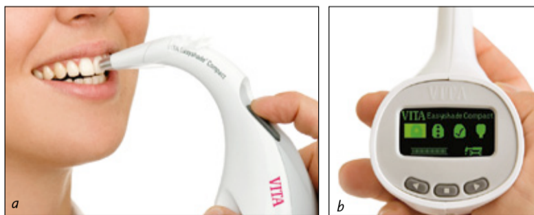
Afb. 5.3a en b De EasyShade Compact (een apparaat voor puntmeting). De tip van het instrument wordt op het tandoppervlak geplaatst. Er kan op één of meerdere plaatsen worden gemeten op natuurlijke gebitselementen, restauraties en kleurtafels. Voor een correct resultaat is het zeer belangrijk dat de tip correct wordt geplaatst.
