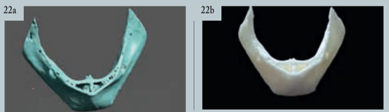
Afb. 21: De PréForm software ontwerpt de steunen op basis waarvan twee verschillende modellen van de onderkaak kunnen worden gemaakt. | Afb. 22a en b: Het virtuele oppervlakmodel (a) en de reële 3D-afdruk van het model (b).
