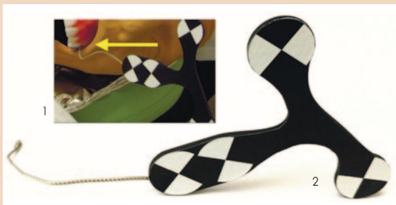
Рис. 6. Маркер Jaw-Tracker зафиксирован на челюсти (1). В процессе трассировки система показывает процент выполнения задачи (2).
