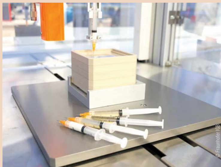
Spritzen mit verschiedenen Biotinte-Formulierungen.
