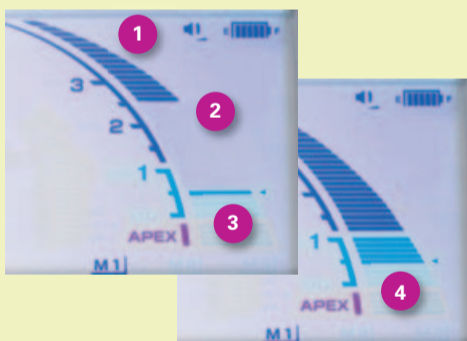
(1) Großes Farb-Display, (2) Farbige Balkenanzeige, (3) Variable Arbeitslängen-Anzeige, (4) Grüner Indikator zur Darstellung des Apex
