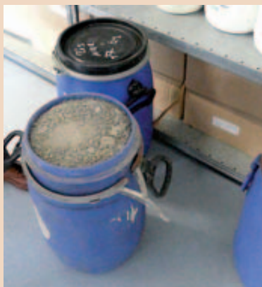
Vorstufe des Recyclings: Getrockneter Amalgamschlamm.
