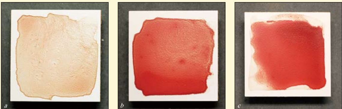
图3：使用被测试的高浓度含醇消毒剂处理后瓷砖表面仍有生物负载污染残留：a) 稀释至10%，b) 稀释至50%，c) 100%未稀释全血。
