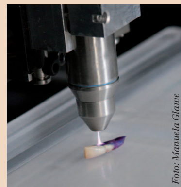
Plasmapbehandlung von Plaque (blau gefärbt) auf einer Zahnwurzel eines extrahierten Zahns.
