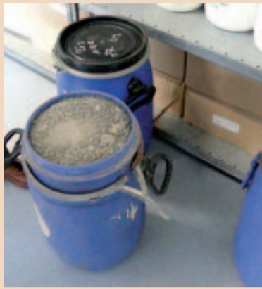
Vorstufe des Recyclings: Getrockneter Amalgamschlamm.
