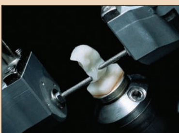
Şekil 4. CEREC 3 cihazına ait freze ünitesi.
