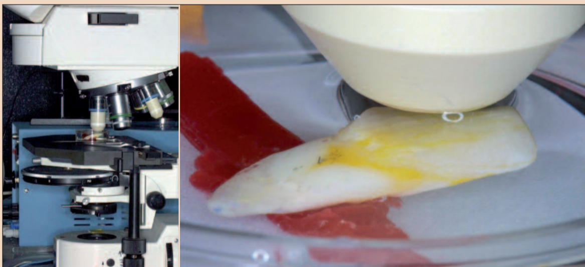
Рис. 2а, б. Общие условия проведения софокусной микроскопии (а). Спряленный участок поверхности резца размещен перпендикулярно лучу лазера (б). Образец погружен в дистиллированную воду.
