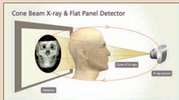
1. ábra: A Cone Beam CT működési elve.
