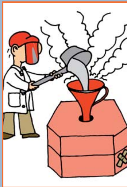
In den entstandenen Hohlraum wird flüssige Metalllegierung (z.B. Gold) gegossen.
