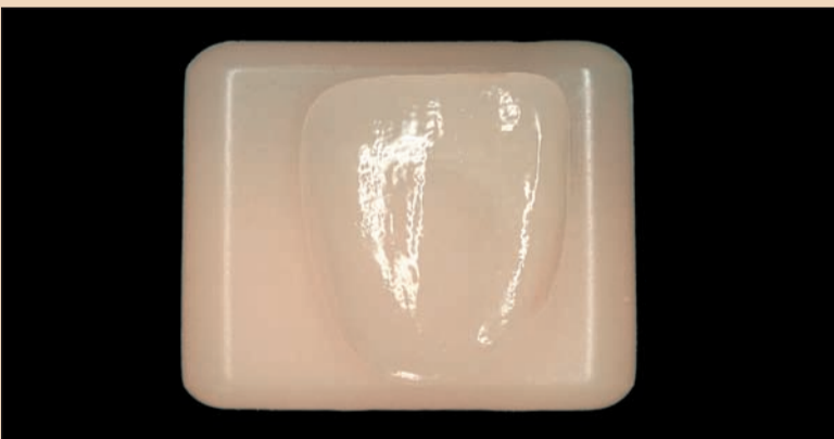
Şekil 5. IPS Empress CAD Multi Block kullanılmış. Bu blok renk ve translüsentlik açısından doğal görünümlü bir geçiş sergiler.
