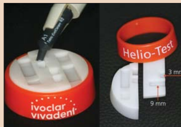
Рис. 1. Упрощенный Heliotest компании Ivoclar Vivadent; заполняется композитными материалами и разбирается на части.
