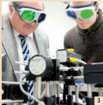
Abb. 3: Prof. Frentzen und Florian Schelle beobachten, wie der „Laser-Meißel“ die quadratische Elfenbeinprobe bearbeitet.
