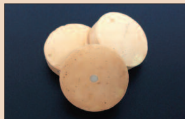
Рис. 1. Исследуемые образцы – гипсовые цилиндры с СИЦ.
