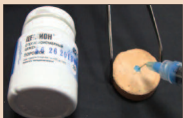
Рис. 4. Нанесение ортофосфорной кислоты на поверхность цемента.
