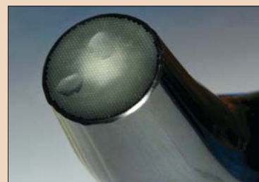
Рис. 3. Остатки бондинга и композитного материала на кончике световода.
