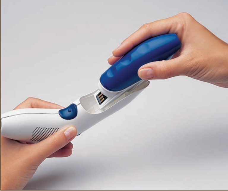
Şekil 5. Bluephase Ivoclar Vivadent'in 'Click&Cure' özelliği sayesinde pil çıkarılınca cihaz doğrudan güç kaynağına bağlı çalıştırılabilir.
