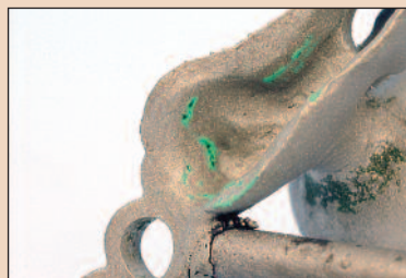
Рис. 20. Снимок областей трения на супраструктуре, сделанный под микроскопом; цветной лак позволяет четко видеть участки абразии металла.
