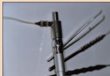
Рис. 2. Имеются адаптеры для всех типов турбинных наконечников (а также систем подачи сжатого воздуха в лабораториях).
