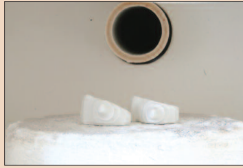
Рис. 19. Штампки после обжига в печи.
