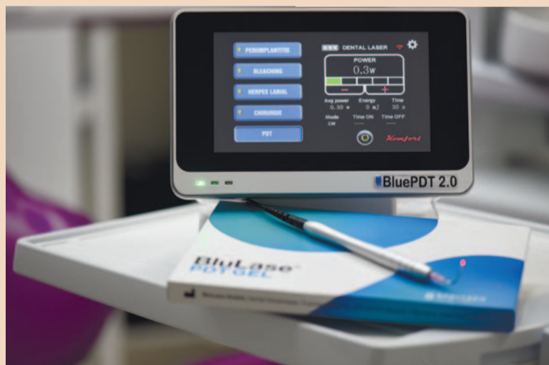
Рис. 7. Пример удобного сенсорного экрана для выбора различных вариантов воздействия, запрограммированных производителем лазера (Schneider Dental)
