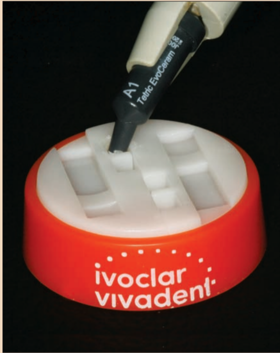
Şekil 1. Ivoclar Vivadent Heliotest. Kompozit rezinle doldurulur ve parçalarına ayrılır.
