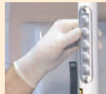
Commande de réglage du flux d'air continu permettant de conserver la propreté du miroir.
