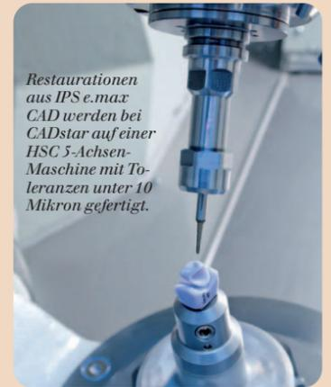
Restaurationen aus IPS e.max CAD werden bei CADstar auf einer HSC 5-Achsen-Maschine mit Toleranzen unter 10 Mikron gefertigt.
