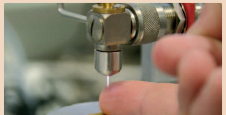
Im Bild die am IOM Leipzig entwickelte miniaturisierte Plasmaquelle mit gezündetem Plasmajet.
