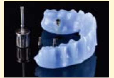
图3: 烧结支架。小突起在烧结过程中为支架提供了支撑。
