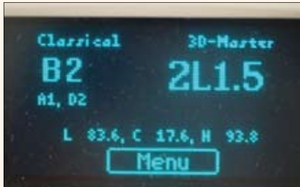
Medición de color en la pantalla del espectrofotómetro y muestra color B2.
